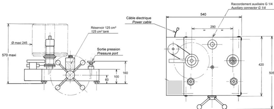
Hauteur avec jeu de poids standard : (bar, kPa) : 375 mm (PSI) : 370 mm
