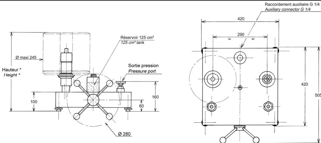
Hauteur avec jeu de poids standard : (bar, kPa) : 410 mm (PSI) : 420 mm
