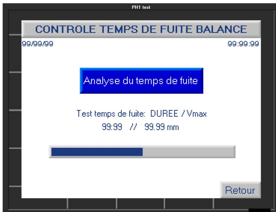
Cet écran, analyse le temps de fuite de la balance en comparant sa vitesse de descente avec les éléments renseignés dans les paramètres constructeur (**Fonctionnalité du bouton F3**).
