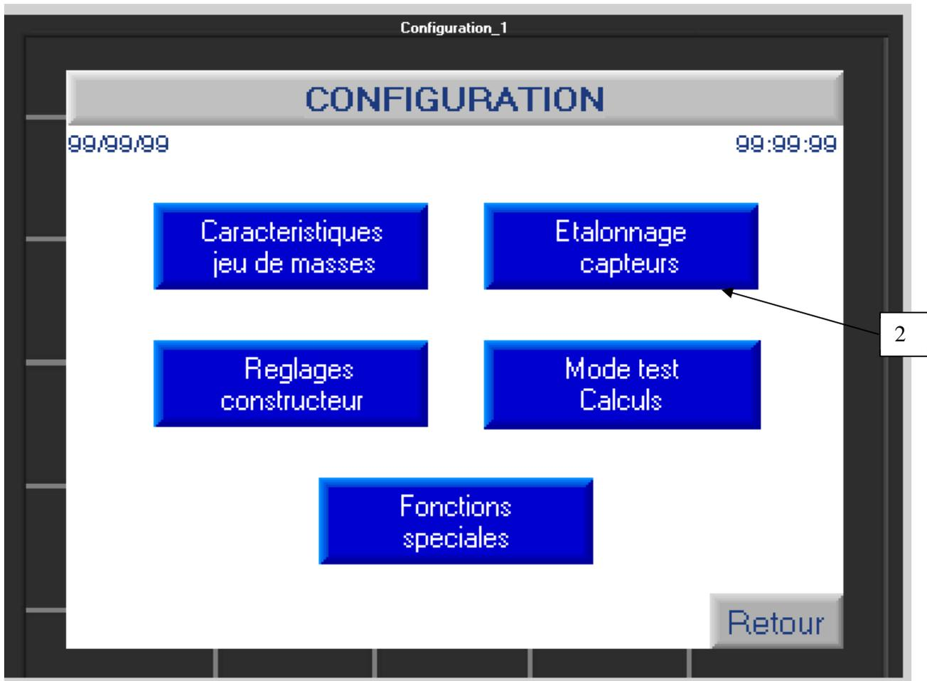
Pour accéder à la fonction d'étalonnage des capteurs, clique sur le bouton (2) + le code d'accès **1993**. L'écran suivant apparaît :
