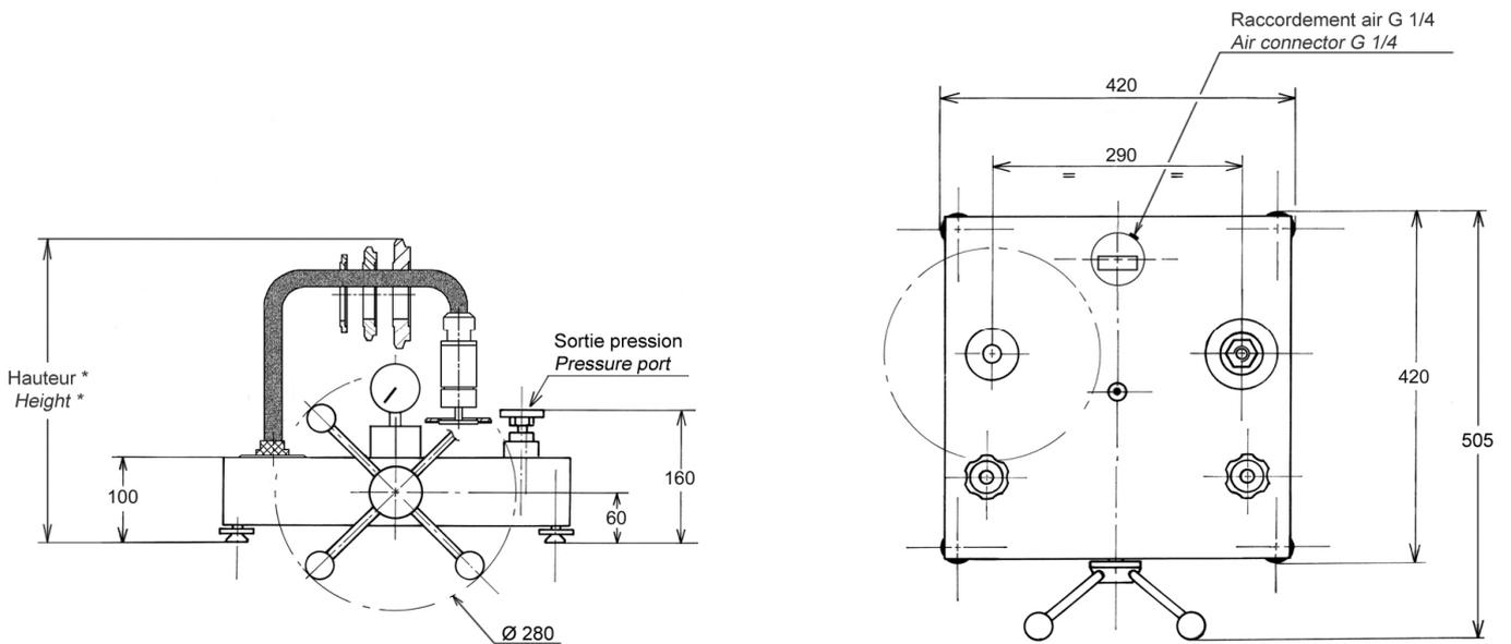
Hauteur avec jeu de poids standard : (mbar, mmH<sub>2</sub>O, kPa) : 410 mm
