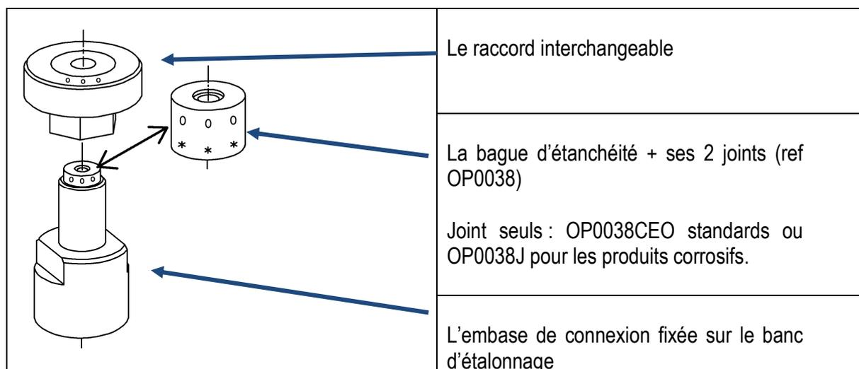
Il est nécessaire d'orienter correctement la bague d'étanchéité en fonction du type de raccord.
