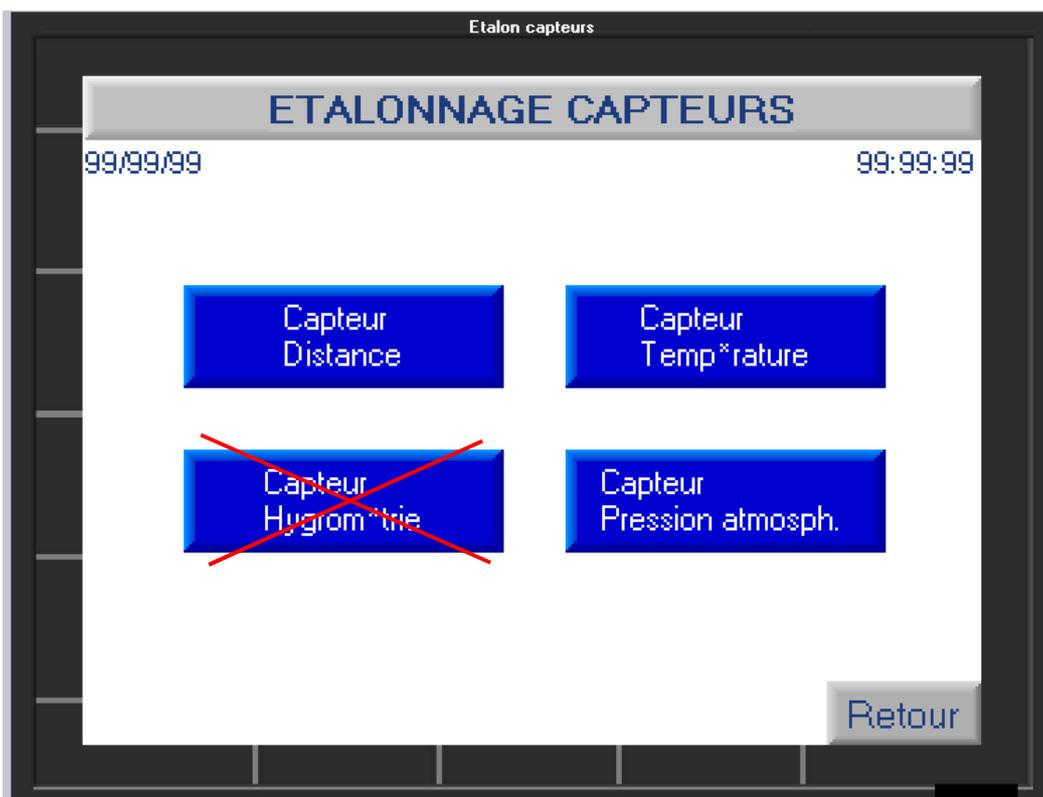
En cliquant sur le bouton adéquate, vous pourrez accéder aux caractéristiques du capteur et saisir les valeurs de correction nécessaires. Chaque champ en bleu est modifiable et vous permet de saisir une valeur de correction. En cliquant dessus, un clavier numérique apparaîtra pour la saisie.
