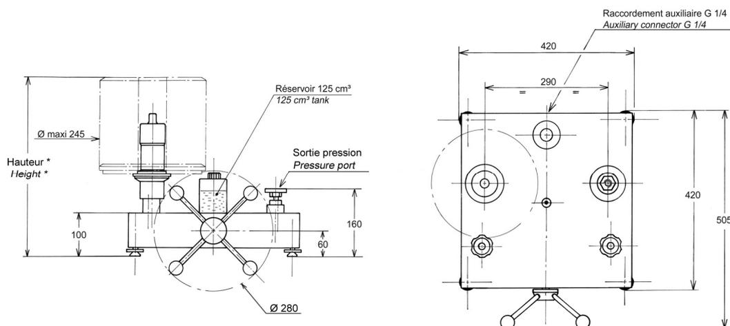
Hauteur avec jeu de poids standard : (bar, kPa) : 360 mm (PSI) : 360 mm
