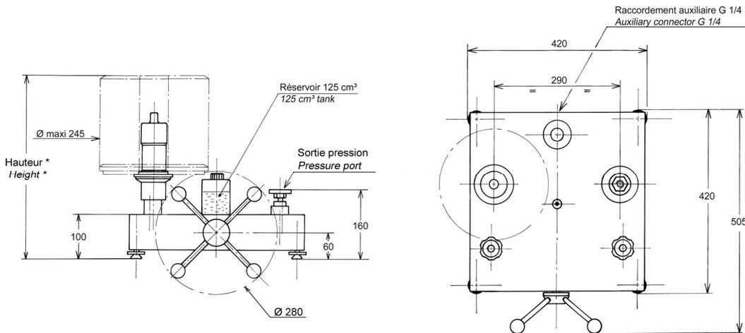
Hauteur avec jeu de poids standard : (bar, kPa) : 430 mm (PSI) : 420 mm
