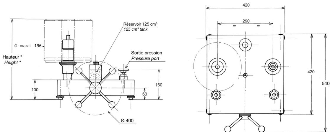
Hauteur avec jeu de poids standard : (bar, kPa) : 430 mm (PSI) : 000 mm
