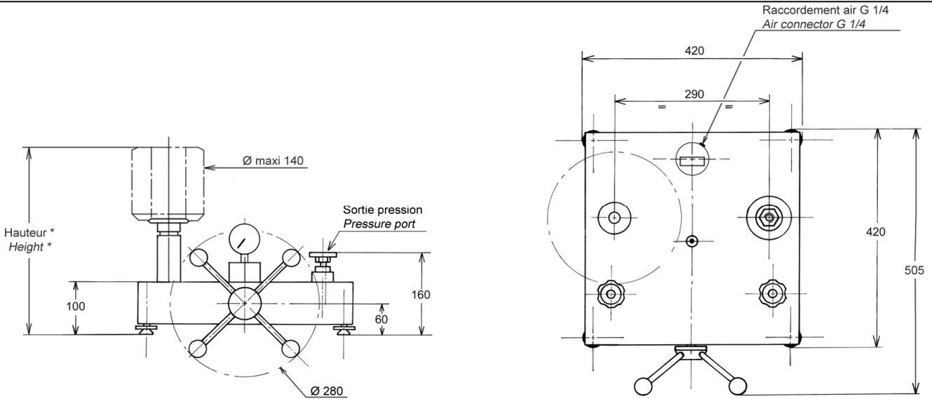
Hauteur avec jeu de poids standard : (mbar, mmH<sub>2</sub>O, kPa) : 315 mm
