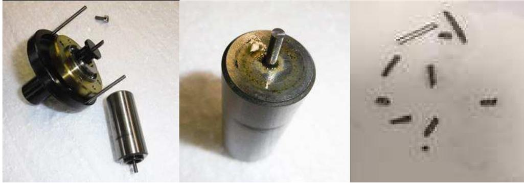
Tous nos pistons sont uniques, car la dernière étape de fabrication nécessite une opération de rodage réalisée à la main par notre technicien. Cette opération est indispensable pour obtenir le meilleur résultat de mobilité et précision de votre balance manométrique. Il nous est donc impossible de fabriquer 2 fois le même piston, chaque balance est unique.
