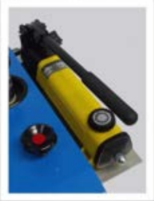
Pompe de gavage
